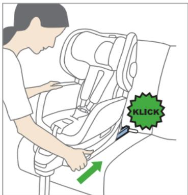
左右のISOFIXコネクタを、車両のISOFIX取付け金具へカチッと音がするまでしっかり押し込みます。
