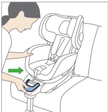
ISOFIXコネクタ調整レバーを引き上げたまま、シートベースが車両座席の背もたれに接するように本体を押し付けてください。
