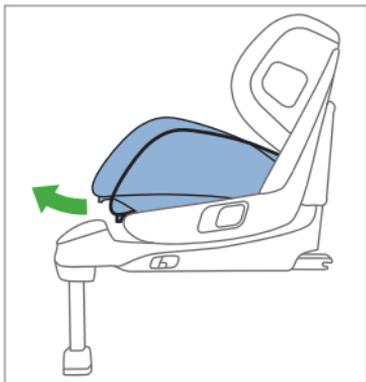
リクライニングレバーから手を離し、シートシェルの座面部分を前後にゆすり、リクライニングが確実に固定されているかを確認してください。
