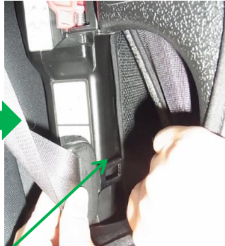
本体樹脂と縫製カバーのスキマへベルトを挿入する
