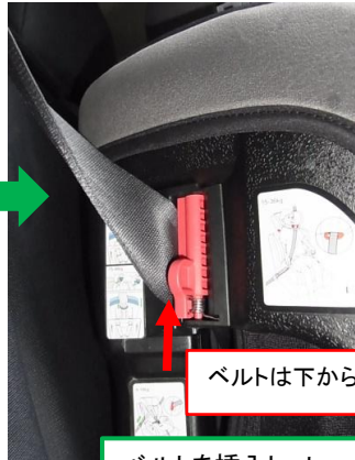
ベルトを挿入し、レバーを元に戻す
